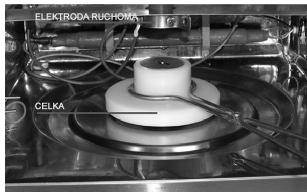
Rys. 2. Komora urządzenia do generowania pulsacyjnego pola elektrycznego (PEF) ERTEC SU-1 z widoczną celką badawczą i elektrodą [11]
