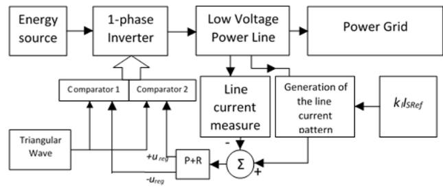
Fig.6. Schemat blokowy układu do badań symulacyjnych, zaimplementowany do układu FPGA.
