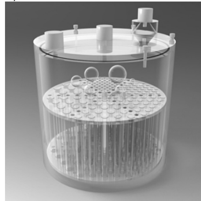
Rys. 1. Fantom PET, który spełnia wymagania standardów NEMA 2007/IEC 2008 [4]
