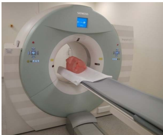
Rys. 3. Testowany skaner PET/CT, na stole pomiarowym widoczny fantom zabezpieczony folią, aby zabezpieczyć podłoże przed ewentualną kontaminacją
