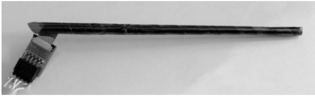
Rys. 2. Sonda pomiarowa razem ze złączem pomiarowym.
