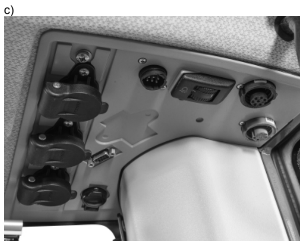
Rys. 3. Urządzenia w kabinie ciągnika: a) urządzenia wspomagające czynności technologiczne nawożenia organicznego, b) System ISOBUS skonfigurowany do nawożenia mineralnego, c) gniazda zasilające w ciągniku Fendt [12, 13]
