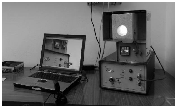
Rys.1. Piec indukcyjny do oznaczania topliwości popiołu z biopaliw stałych
