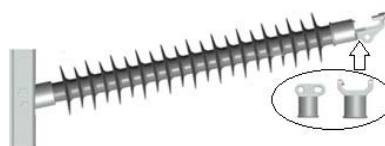
Rys. 8. Izolator wsporczy stosowany w liniach 110 kV [24]
