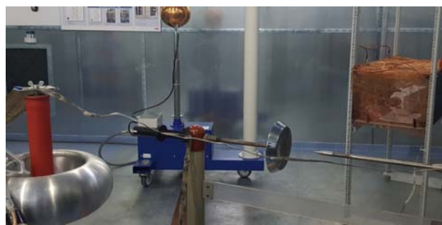
Rys.4. Konfiguracja układu pomiarowego: układ elektrod ostrze-płaszczyna oraz szybka kamera UV w klatce Faradaya
