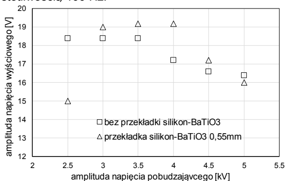
Rys. 3. Zależność napięcia wyjściowego piezoelementu harvestera od napięcia pobudzającego przetwornik elektrostatyczny
