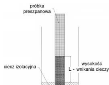
Rys.1. Schematyczna prezentacja testu bazującego na efekcie podciągania kapilarnego
