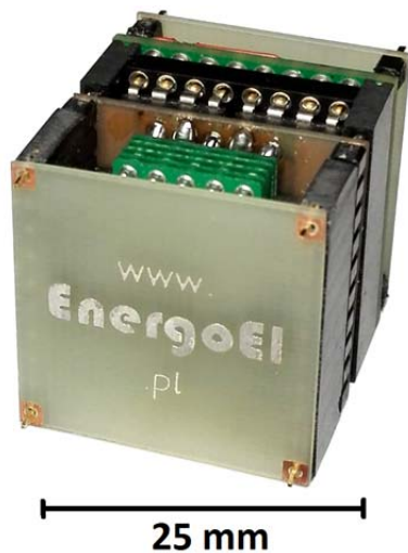
Rys. 5. Fotografia kompletnego modułu przetwornicy dwukierunkowej o mocy 300W
