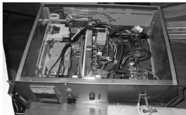
Rys.2. Widok wnętrza zaprojektowanego i zbudowanego urządzenia do grzania indukcyjnego
