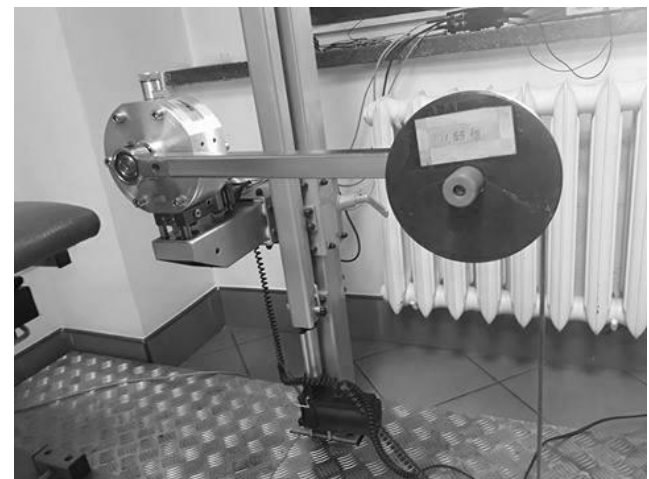
Rys. 5. Stanowisko do wyznaczenia charakterystyki toru pomiarowego i toru sterującego
