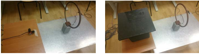
Rys. 7 Konfiguracja izotropowej sondy pola oraz anteny emisyjnej w trakcie kalibracji oraz pomiarów tłumienia obiektu.
