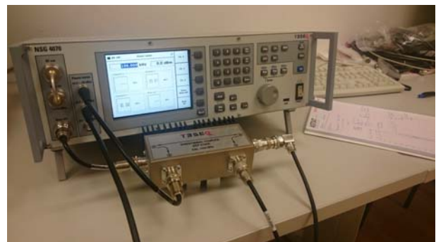
rys. 6 Generator sygnałowy Teseq NSG 4070 oraz sprzęgacz kierunkowy DCP 0100A.
