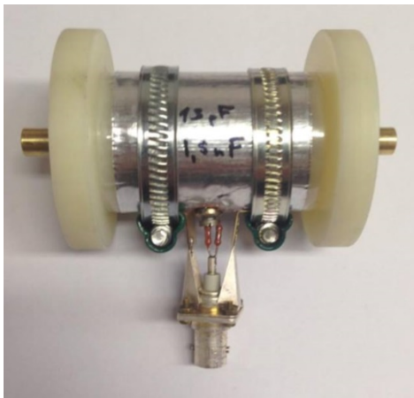
Rys.8. Widok koncentrycznego, pojemnościowego dzielnika napięcia wykonanego w ZWNIKE PW
