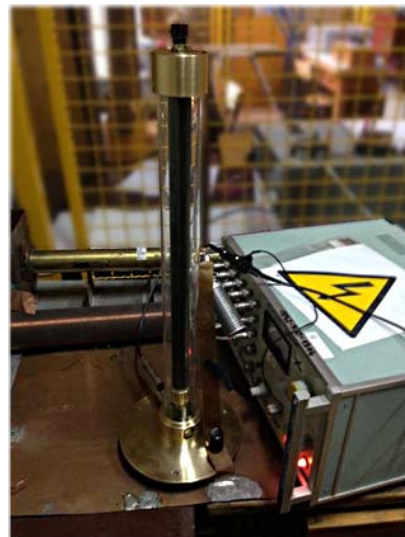
Rys.6. Rezystancyjny dzielnik z niskoindukcyjnymi opornikami ceramicznymi na stanowisku pomiarowym
