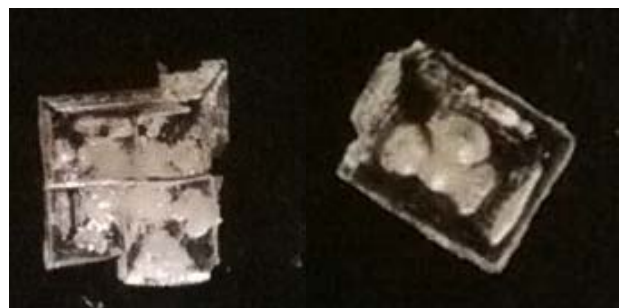
Rys. 2. Przykładowe kryształy KCl wyhodowane metodą rekryształizacji z analitycznie czystego proszku
