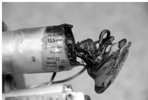
Rys.4. Uszkodzony kondensator w oprawie metalohalogenkowej.
