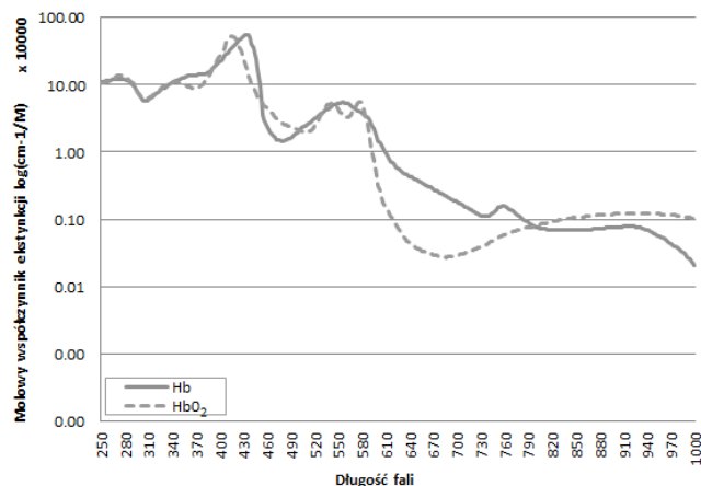
Rys.1. Zdolność absorpcji promieniowania w funkcji długości fali dla hemoglobiny (Hb) i hemoglobiny natlenionej (HbO 2 ) wyrażona w molowych współczynnikach ekstynkcji (na podstawie [1]).
