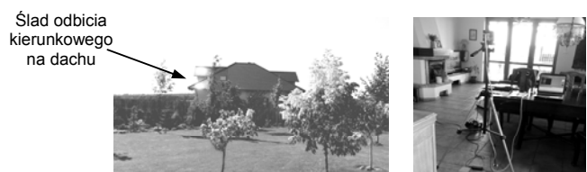
Rys.4 Widok dachu odbijającego kierunkowo i pomieszczenia oświetlonego zewnątrz promieniowaniem odbitym
