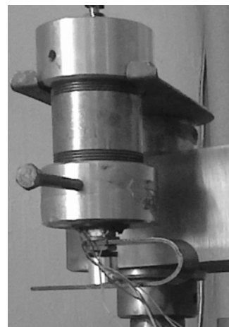
Rys. 4. Wygląd zewnętrzny hermetycznej komory ciśnieniowo-próżniowej do pomiarów AE
