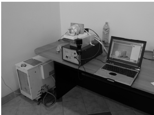
Rys. 2. Zrealizowane praktycznie prototypowe stanowisko laboratoryjne. U dołu układ przekształtnika, powyżej układ wyjściowy, u góry wzбудnik z rurą grafitową.
