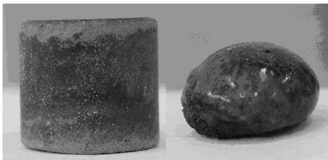
Rys 4. Próbkę popiołu, po lewej przed podgrzaniem, po prawej po osiągnięciu temperatury płynięcia popiołu i po ostudzeniu.
