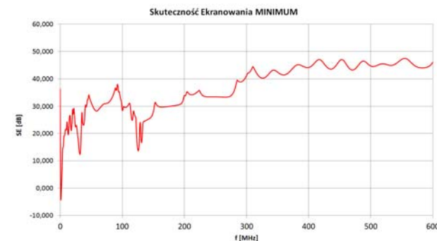
Rys. 8. Wynik końcowy skuteczności ekranowania dla badanej obudowy ekranującej – generator impulsów wysokoenergetycznych
