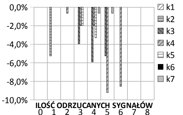
Rys. 3 Zestawienie wartości zmian wskaźników jakości w wyniku implementacji warstw Petriego, wskaźnik B1 (t=0-15s)
