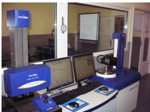
Rys.3. Profilometr Taylor Hobson Talysurf 2D/3D - stanowisko do pomiaru struktury geometrycznej powierzchni
