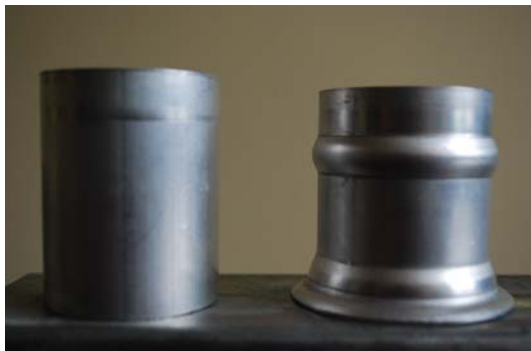
Rys.2. Detal przed i po operacji rozpęczania wykonany na AGH w Krakowie
