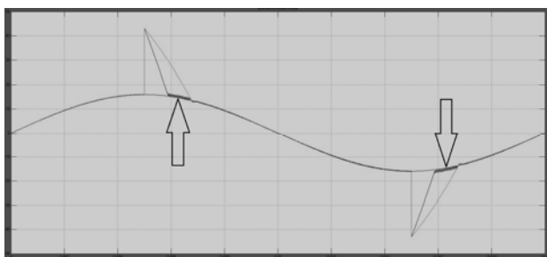
Rys. 8. Prąd referencyjny sieci oraz prądy sieci w przypadku wykorzystania kompensatorów aktywnych (z oraz bez modułu MP)
