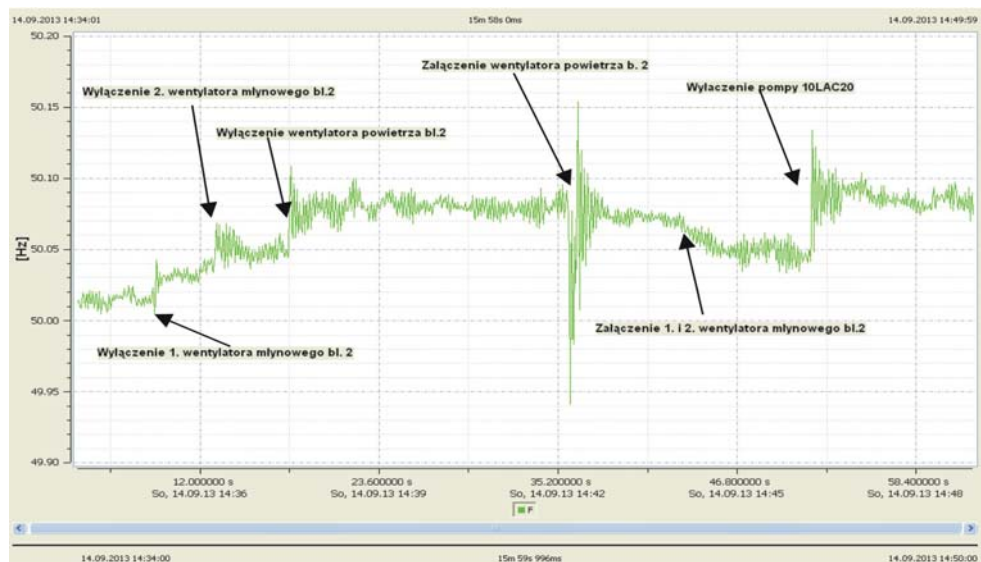
Rys. 10. Częstotliwość w torze wyprowadzenia mocy z turbogeneratora bloku BC 50 podczas zmian obciążeniowych w wyspie
