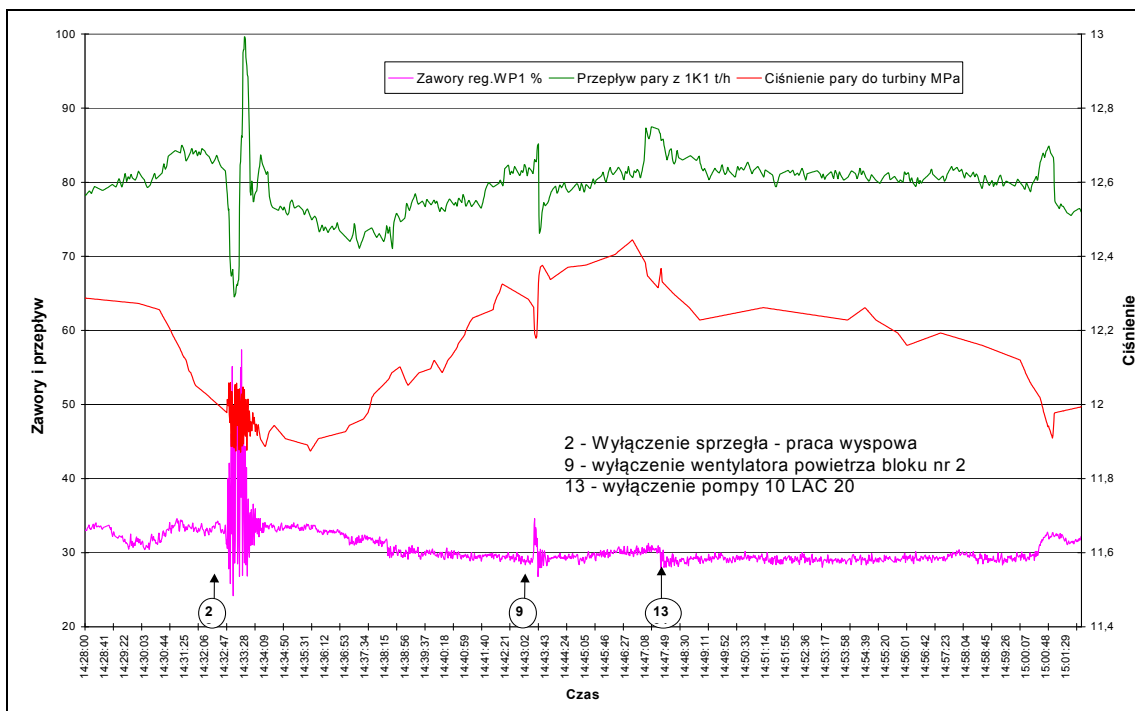
Rys. 6. Zarejestrowane podczas trwania eksperymentu wielkości charakteryzujące pracę układu ciepłego bloku BC 50
