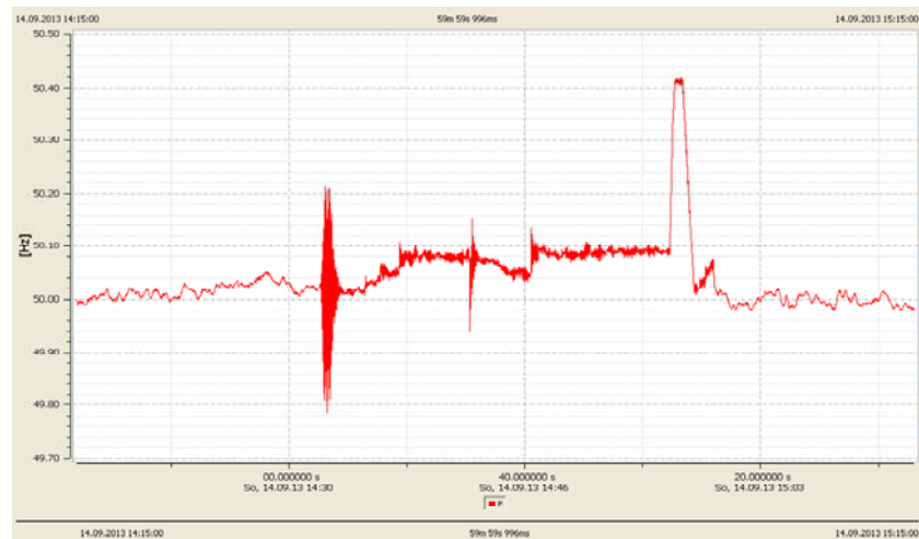
Rys.4. Zmiany częstotliwości w wydzielonym układzie wyspowym zarejestrowane w czasie trwania eksperymentu
