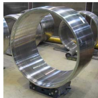
Rys.2. Kołpak na stanowisku do badań nieniszczących
