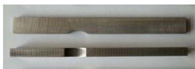
Rys.5. Próbka do badań zmęczeniowych
