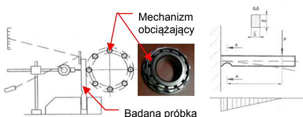
Rys.6. Zasada działania mechanizmu do obciążeń zmęczeniowych i wykres momentu gnącego
