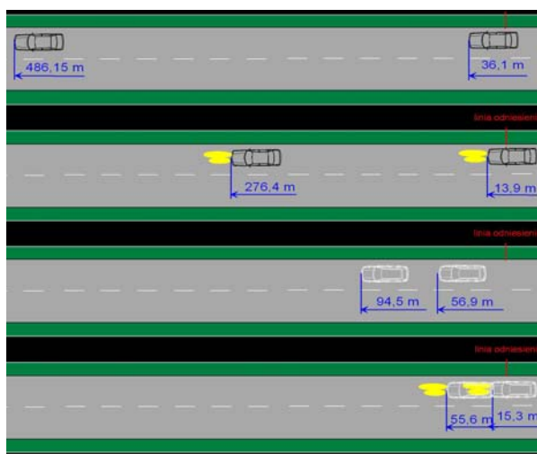
Rys. 6. Graficzne porównanie drogi postrzeżenia samochodu koloru ciemnego i jasnego przy włączonych i światłach mijania /perspektywa z lotu ptaka/.
