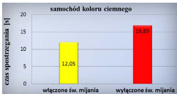
Rys. 4. Średni czas spostrzeżenia samochodu koloru ciemnego, od linii odniesienia, przy włączonych i wyłączonych światłach mijania.
