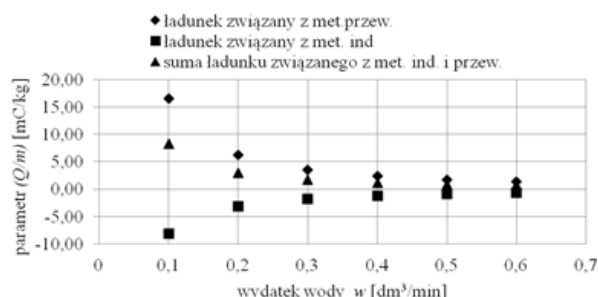
Rys. 13. Bilans parametrów Q/m związanych z elektryzacją metodą przewodnościową oraz metodą indukcyjną dla różnych wydatków wody w (0,1 – 0,6 dm³/min)
