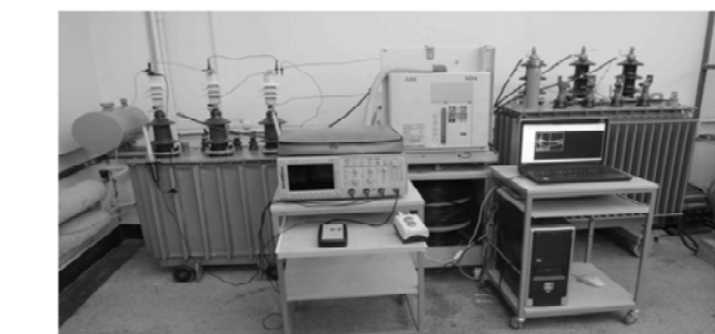
Rys.3. Układ do badań przepięć podczas wyłączania transformatora wyłącznikiem próżniowym: a – schemat układu badawczego, b – widok stanowiska: W – wyłącznik próżniowy, Tz – transformator zasilający, Tr – transformator wyłączający, l_k – linia kablowa o długości 85 m, l_1 – szynoprzewody o długości 2 m, ogr – ograniczniki przepięć, bk – bateria kondensatorów 60 nF
