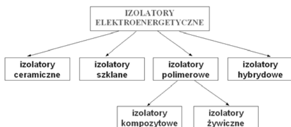
Rys.1. Podział izolatorów elektroenergetycznych ze względu na rodzaj materiału, z którego wykonano ich część izolacyjną
