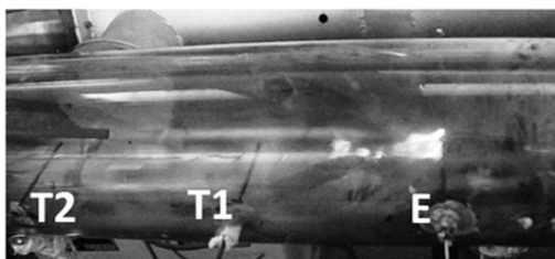
Rys.3. Płomień podczas stabilizacji przy ustawieniu elektrod w odległości 150 mm od dyszy rozpylacza, napięcie łuku 3,30 kV, prąd 50 mA; E – elektrody wyładowcze/zapłonowe, T1 – termopara, T2 – termopara
