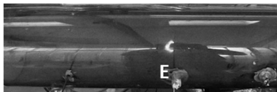
Rys.2. Płomień podczas stabilizacji przy ustawieniu elektrod w odległości 310 mm od dyszy rozpylacza, napięcie łuku 2,6 kV, prąd 51 mA ; E-elektrody wyładowcze/zapłonowe
