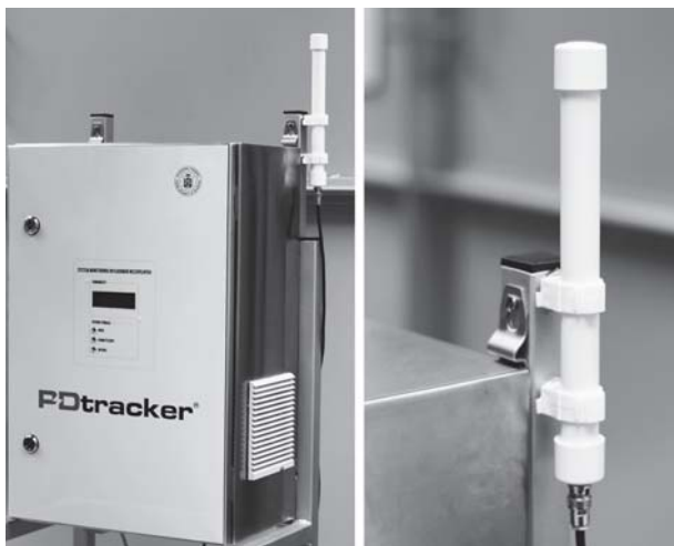
Rys. 9. Sonda do bezkontaktowego pomiaru wysokiego napięcia stosowana w systemie monitoringu PDtracker
